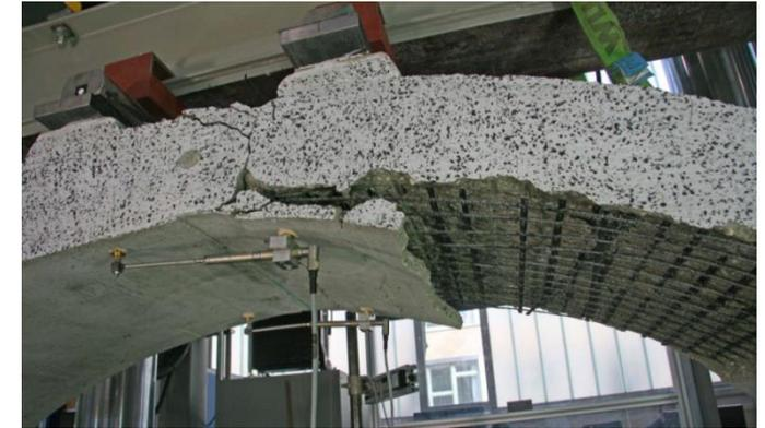
Abplatzungen unter Maximallast
